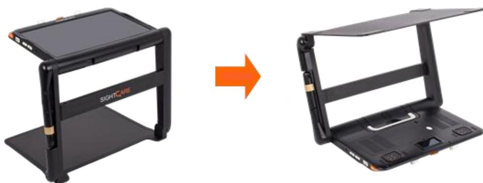
②液晶モニターの背面のバッテリーロック解除ボタンを押しながら、くぼみに指を入れ、バッテリーユニットを引き上げ、外します。
