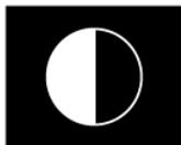
コントラストアイコンをジョグボタンで選択し、左右に動かしてコントラストのレベルの変更が可能です。16段階の中から好みのコントラストの選択できます。ジョグボタンもしくは明るさ調節ボタンとモード切替ボタン同時に3秒以上長押しするとメニュー画面に戻ります。
