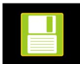
フロッピーアイコンをジョグボタンで選択すると、倍率、モード、明るさ、コントラストなど、自分が使いやすいように設定した状態が保存されます。画面に「User Config Saved」と約2秒間表示されます。
